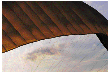
Saubere Hinterkante und Bremsleinenanlenkung
