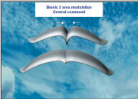
Beim Bionic führt eine spezielle Steuerleine von den inneren Zellen über eine Umlenkung zum Piloten herab. Durch Zug an dieser Leine kann der Pilot im Flug die Flügelmitte herabziehen und die Spannweite sowie die projizierte Fläche verringern. Aber auch im ganz ausgelassenen Zustand bleibt eine leichte „V“-Form in der Flügelmitte.
