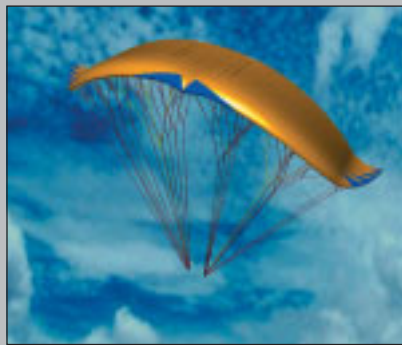
Beim Bionic führt eine spezielle Steuerleine von den inneren Zellen über eine Umlenkung zum Piloten herab. Durch Zug an dieser Leine kann der Pilot im Flug die Flügelmitte herabziehen und die Spannweite sowie die projizierte Fläche verringern. Aber auch im ganz ausgelassenen Zustand bleibt eine leichte „V“-Form in der Flügelmitte.
