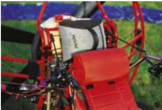
Das Rettungsgerät ist hinter der Kopfstütze angebracht
