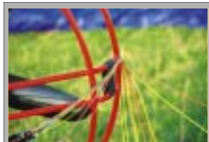
Für den Start laufen die Fangleinen durch eine entsprechende Führung am Propellerkäfig
