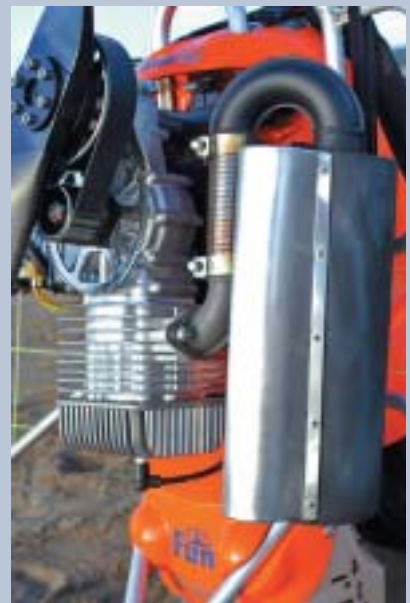
Blasinstrument: der eigens entwickelte Resonanzauspuff sorgt für gute Leistung
