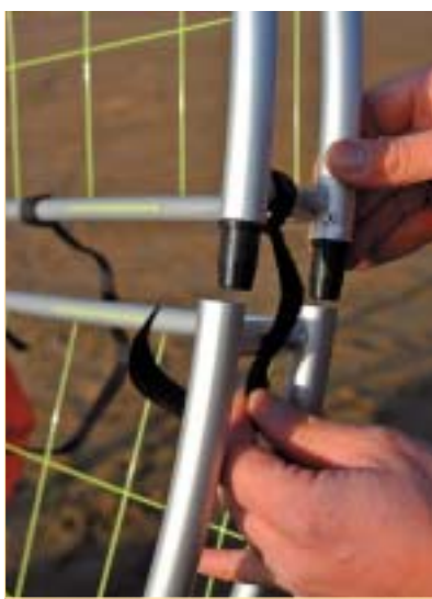
Die konischen Paßstifte stellen eine interessante Weiterentwicklung dar - sie sorgen für eine leicht erhöhte Käfigstabilität
