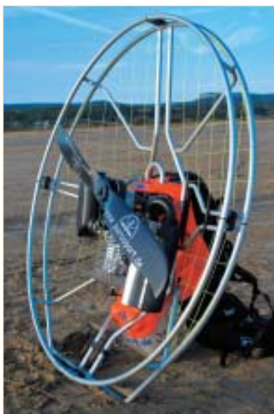
Standfest: nach wenigen Minuten ist das System komplett aufgebaut und steht recht kippsicher auf Tank und Käfig
