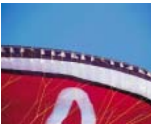
Cayenne-Eintrittskante: Teilweise geschlossene Eintrittsöffnungen und ein modernes Diagonalrippenkonzept (Einzelzellen wechseln mit 3er-Diagonalrippenverbund)
