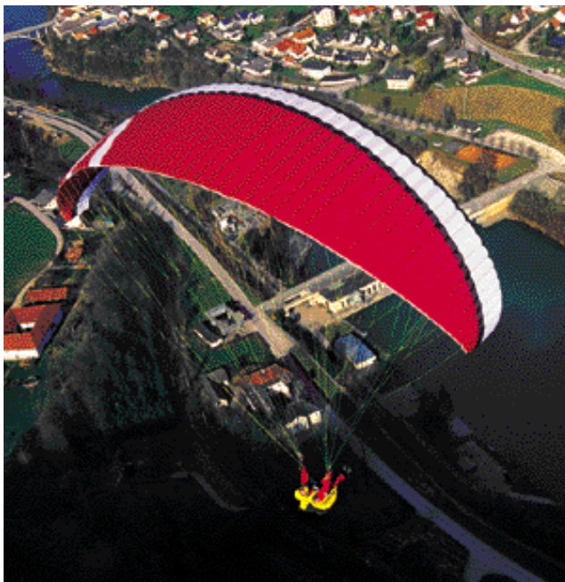
Cayenne-Eintrittskante: Teilweise geschlossene Eintrittsöffnungen und ein modernes Diagonalrippenkonzept (Einzelzellen wechseln mit 3er-Diagonalrippenverbund)
