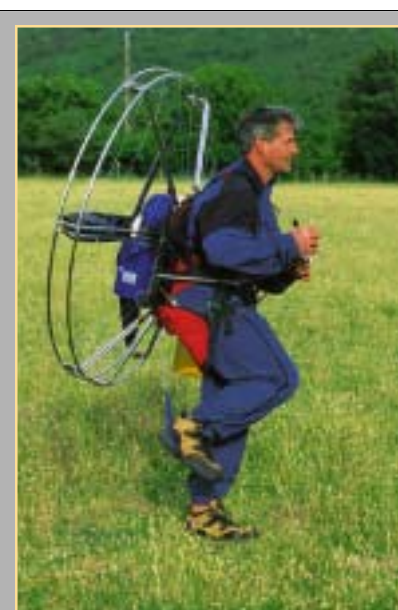
Gut platzierte Anlasserleine: Der Motor kann auch per Fußtritt zum Laufen gebracht werden.
