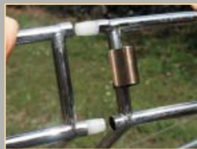
Solide verbunden: Käfigsystem mit Plastikstiften und Metallklammer
