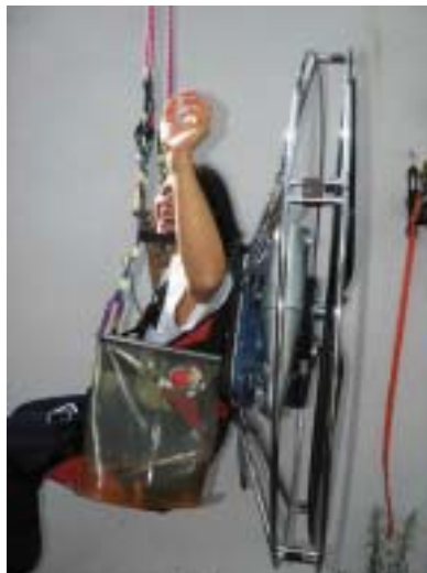
Zum Lachen oder zum Weinen? Eigenwilliges Aufhängungskonzept mit tiefer Stange und Stabilisierungs-Riemen am Tragegurt
