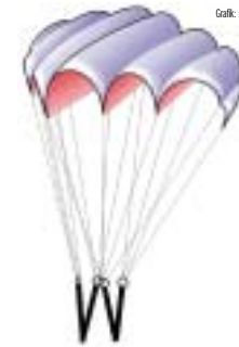
Lenkbare Rettung nach dem Rogalloprinzip: Eine einfache Fläche bringt genügend Auftrieb, um eine gewisse Vorwärtsfahrt zu ermöglichen.
