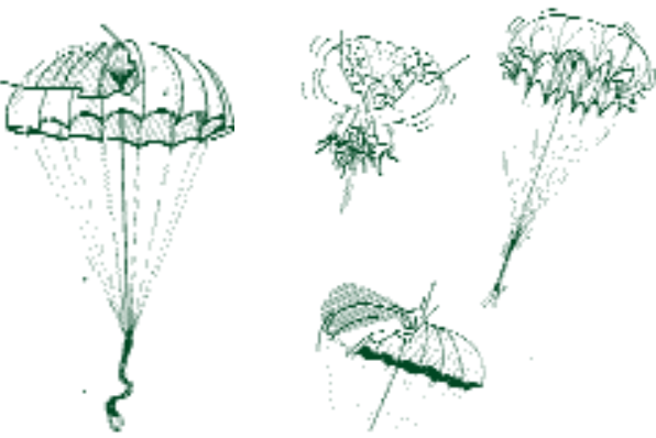
Leine und Loch: Das System „Pull Down Apex“ hat sich bei den Rundkappen vollkommen durchgesetzt. Die Kuppel der Kappe wird dank der Mittelleine herabgezogen, und ein Loch im Scheitel sorgt für eine aerodynamisch günstige Strömung. Resultat: schnellere Öffnung, geringeres Sinken. Allerdings kann die Pendelstabilität leiden.
