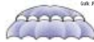
Doppelte Arbeit: Die Doppelkappe ist etwas aufwendiger in der Herstellung und etwas umständlicher beim Packvorgang.
