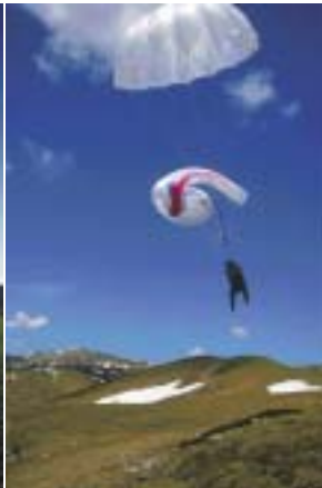
Doppelter Vorteil: Das Prinzip der Mehrfachkappe bringt nicht nur eine schnellere Öffnung, sondern auch einen stabileren Sinkflug
